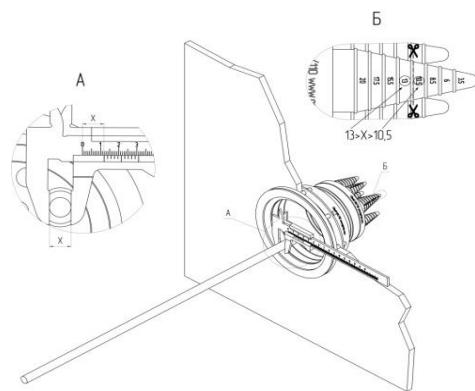
j) Вставьте трубу с кабелями в гермоввод. Затяните хомутом, что бы получить герметичное уплотнение между трубой и гермовводом.
