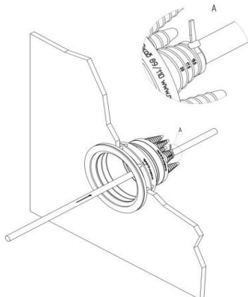
i) С внутренней стороны вставьте фланец (кольцо) и затяните гайки.
